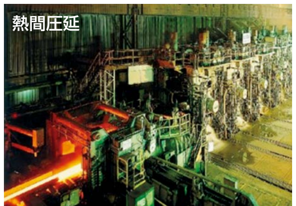
時速100kmで流れる全長2kmの鋼板の板厚をマイクロオーダーで制御する。
