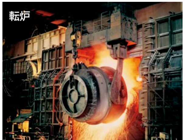
400ton、1500℃の溶鋼の成分をPPM(100万分1)オーダーでの中させる。
